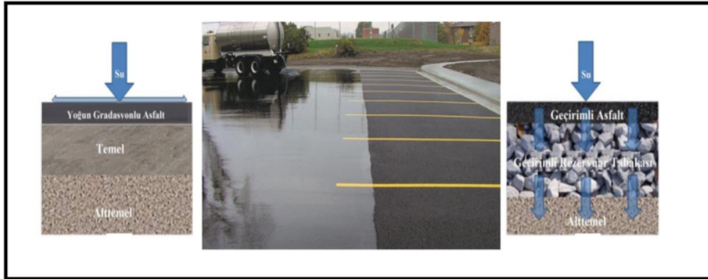
Şekil 2. Geleneksel ve geçirimli asfalt yüzeylerde drenaj (Topaloğlu, 2019)
